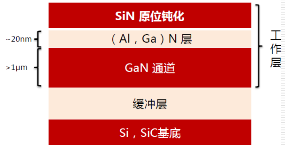
图表:GaN射频器件结构示意图
